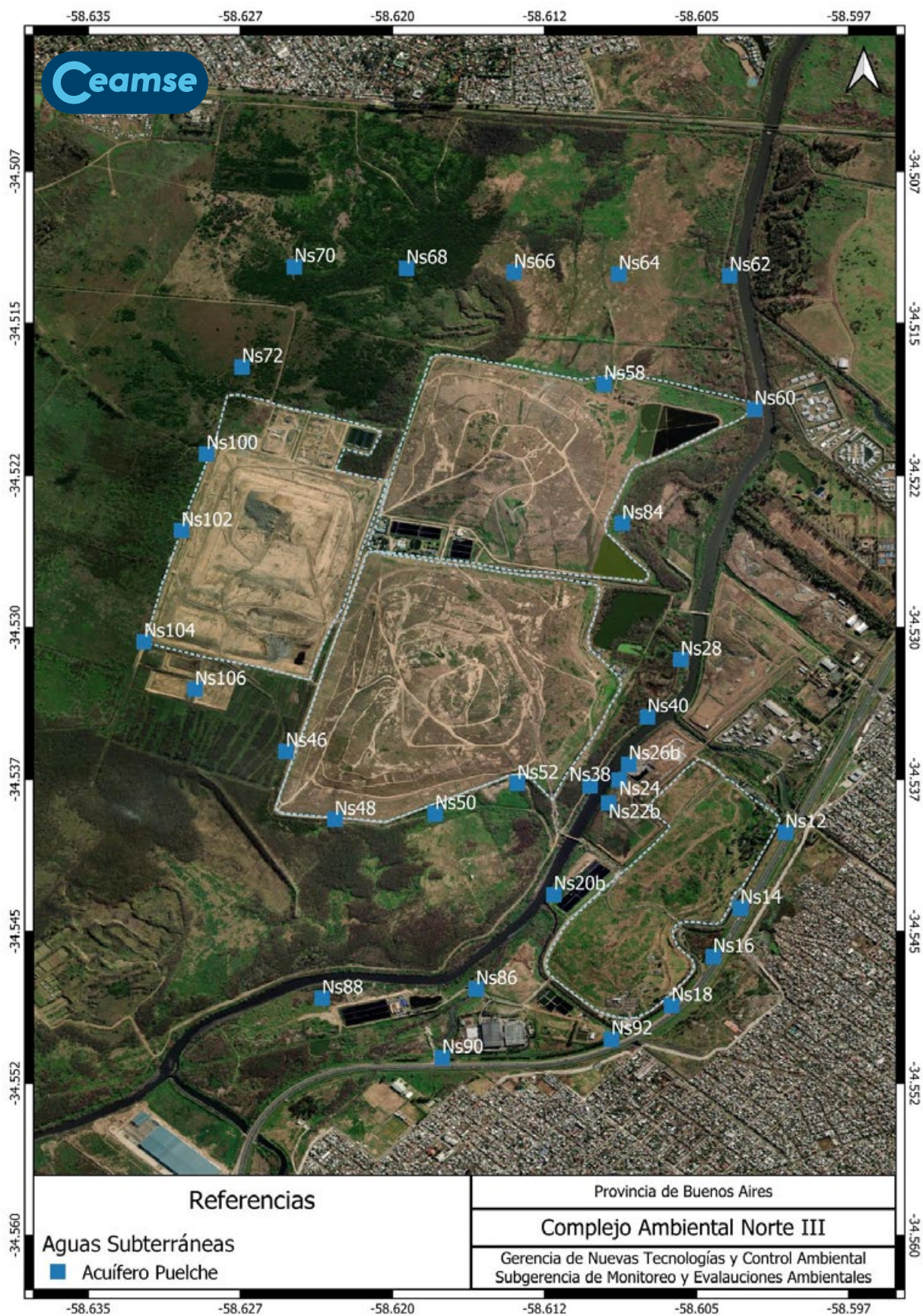
Pozos de Monitoreo de Agua Subterránea Acuífero Puelche– C. A. Norte III
